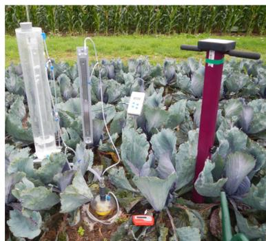
Abb. 2: Messung der Infiltrationsrate mit Haubeninfiltrometer und der Bodenfeuchte mit mobilem TDR-Gerät
